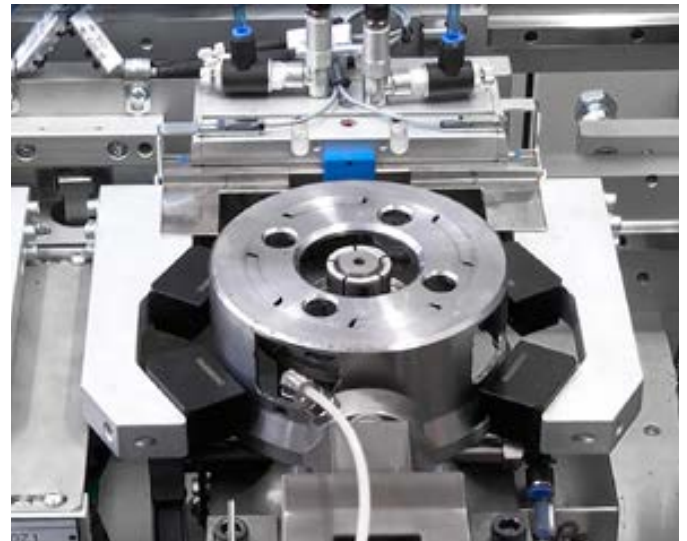
Impianto automatico per la correzione di componenti automobilistici (parti del cambio) con correzione automatica tramite punzonatura orizzontale completa di caricatore lineare e nastri trasportatori.
